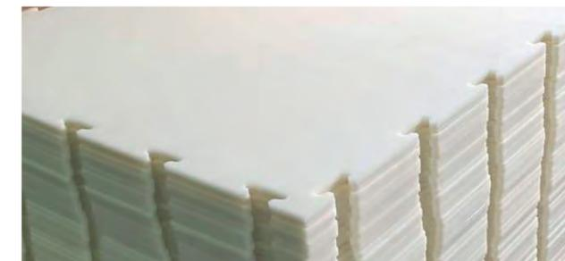
СИНТЕТИЧЕСКИЕ ПАНЕЛИ ИЗ INKULEN PE ИСПОЛЬЗУЕТСЯ ДЛЯ ОБЛИЦОВКИ БОРТОВ И ЗАМЕНЫ ЛЕДОВОГО ПОКРЫТИЯ (ИСКУССТВЕННЫЙ ЛЕД)
