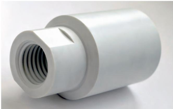
ГАЙКА С РЕЗЬБОЙ TR40x5 L=80MM ИЗ ZX-100K ВЫДЕРЖИВАЕТ >5ТОНН НАГРУЗКИ
