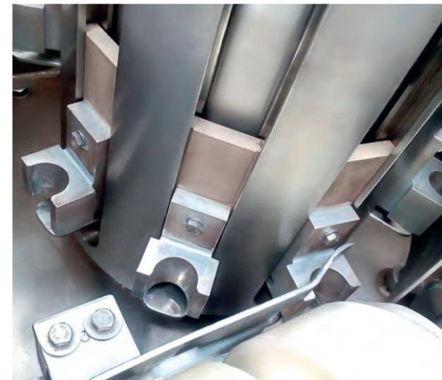
НАПРАВЛЯЮЩАЯ ЗАХВАТА ДЛЯ МОЙКИ ФЛАКОНОВ ИЗ ZX-550 ИСПОЛЬЗУЕТСЯ НА ЛИНИИ ФАСОВКИ ЛЕКАРСТВЕННЫХ ПРЕПАРАТОВ BOSCH. НЕ ВПИТЫВАЕТ ВЛАГУ И РАБОТАЕТ В ГОРЯЧЕЙ ВОДЕ
