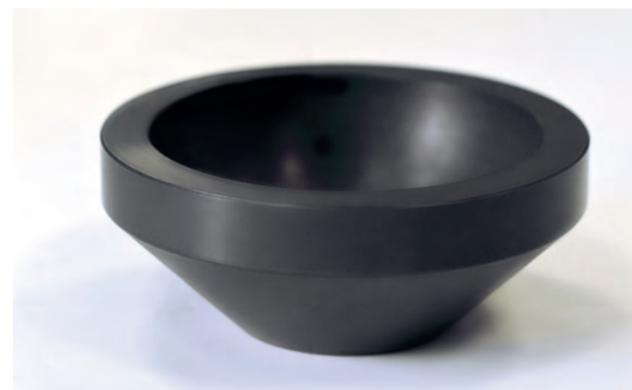
СФЕРИЧЕСКАЯ ОПОРА ИЗ ZX-324 С ДИАМЕТРОМ ШАРИКА 60ММ. РАБОТА БЕЗ СМАЗКИ ПРИ  $t$  ДО 250°C, НАГРУЗКЕ ДО 30 ТОНН С УДАРАМИ И ПРИ НАЛИЧИИ ЗАГРЯЗНЕНИЙ
