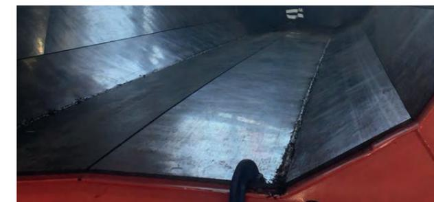
ФУТЕРОВКА INKULEN PE ПРОИЗВОДИТСЯ КАК ВСЕГО КУЗОВА САМОСВАЛА, ТАК И ЕГО ЧАСТИ, НАИБОЛЕЕ ИЗНАШИВАЕМЫХ УЧАСТКОВ КУЗОВА
