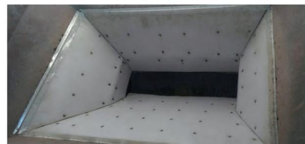
ФУТЕРОВКА ИЗ INKULEN PE В СРЕДНЕМ СЛУЖИТ В 4-5 РАЗ ДОЛЬШЕ МЕТАЛЛИЧЕСКОЙ ФУТЕРОВКИ
