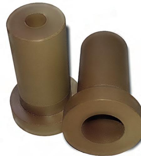
ВТУЛКИ ИЗ ZX-750 ИСПОЛЬЗУЮТСЯ В УЗЛЕ ЗАПАЙКИ ТРЕЙСИЛЕРА ISHIDA QX1100 ПРИ ТЕМПЕРАТУРЕ 280-300°C. УВЕЛИЧИВАЮТ СРОК СЛУЖБЫ ЗА СЧЁТ ВЫСОКОГО pV-ЗНАЧЕНИЯ
